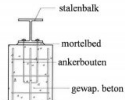
DETAIL OPLEGGING EN VERANKERING STALEN BALKEN
